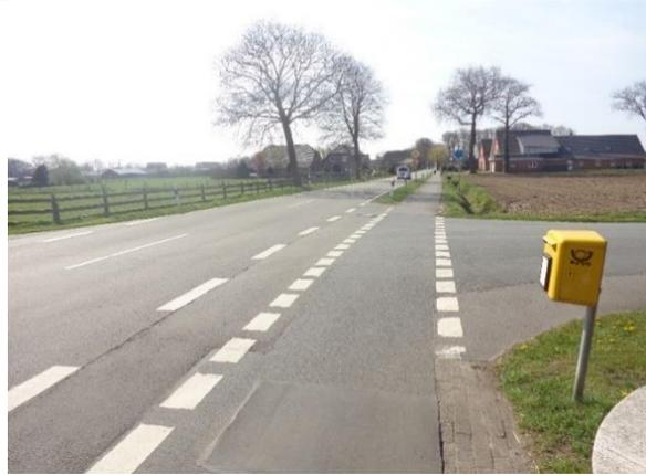
Abb.: Getrennte Fahrbahnen von Straße und Fuß- und Radweg mit Markierung
