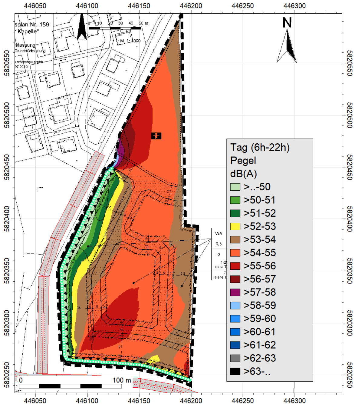
Abbildung 3: Beurteilungspegelverlauf im Tagzeitraum auf dem Plangebiet unter Berücksichtigung von den Geräuschemissionen durch den Straßenverkehr mit einer 5 m hohen Lärmschutzwand (turquoise Linie), relative Aufpunkthöhe: 2 m für das Prognosejahr 2030.
