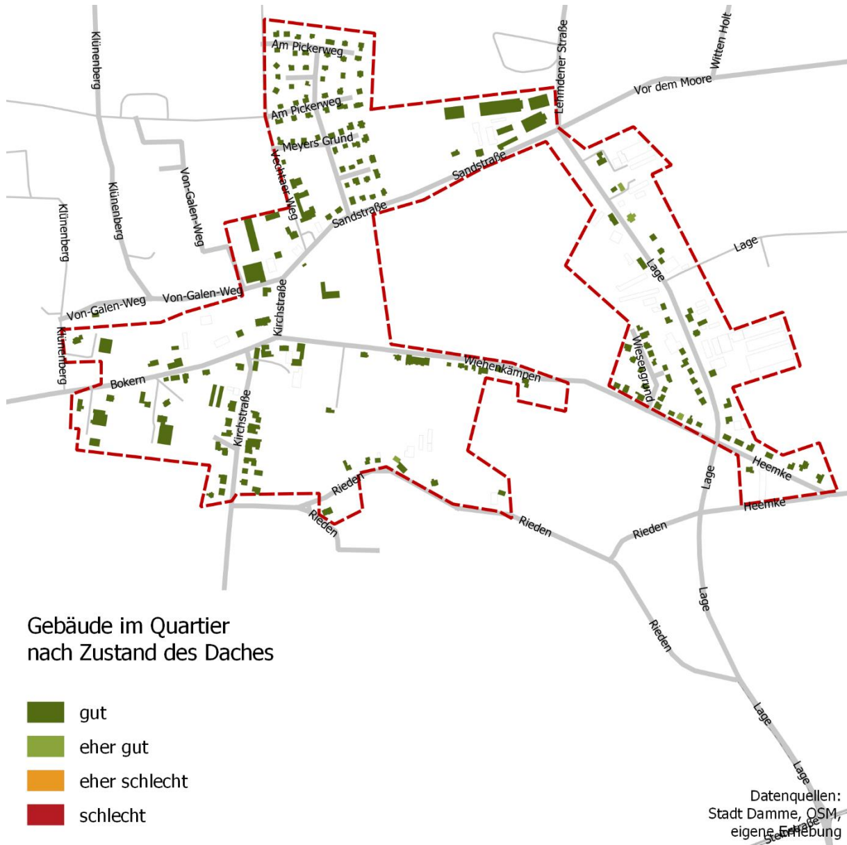
Abbildung: Gebäude im Quartier nach Zustand des Daches
