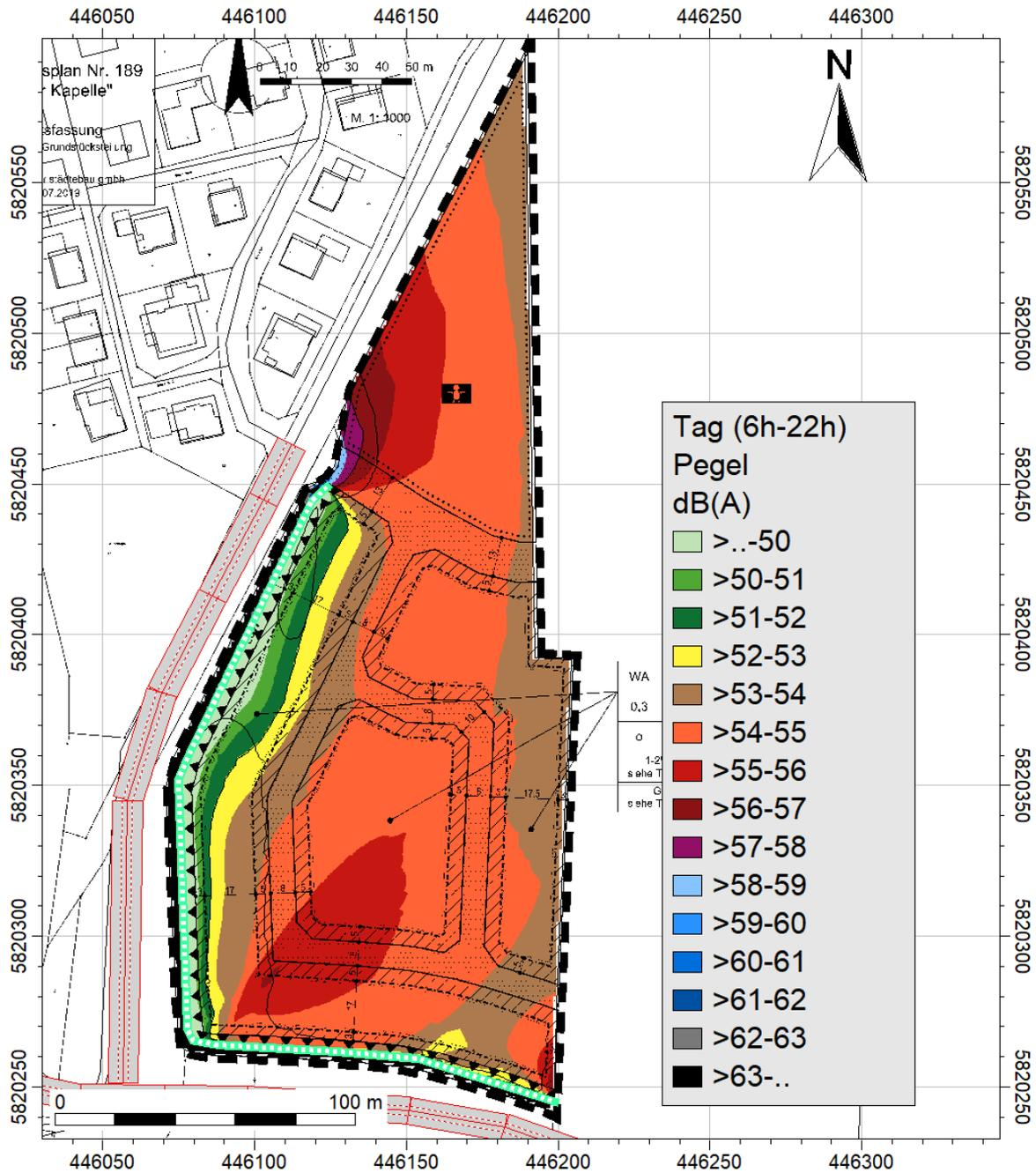
**Abbildung 3:** Beurteilungspegelverlauf im **Tagzeitraum** auf dem Plangebiet unter Berücksichtigung von den Geräuschemissionen durch den Straßenverkehr mit einer 5 m hohen Lärmschutzwand (turquoise Linie), **relative Aufpunkthöhe: 2 m** für das Prognosejahr 2030.
