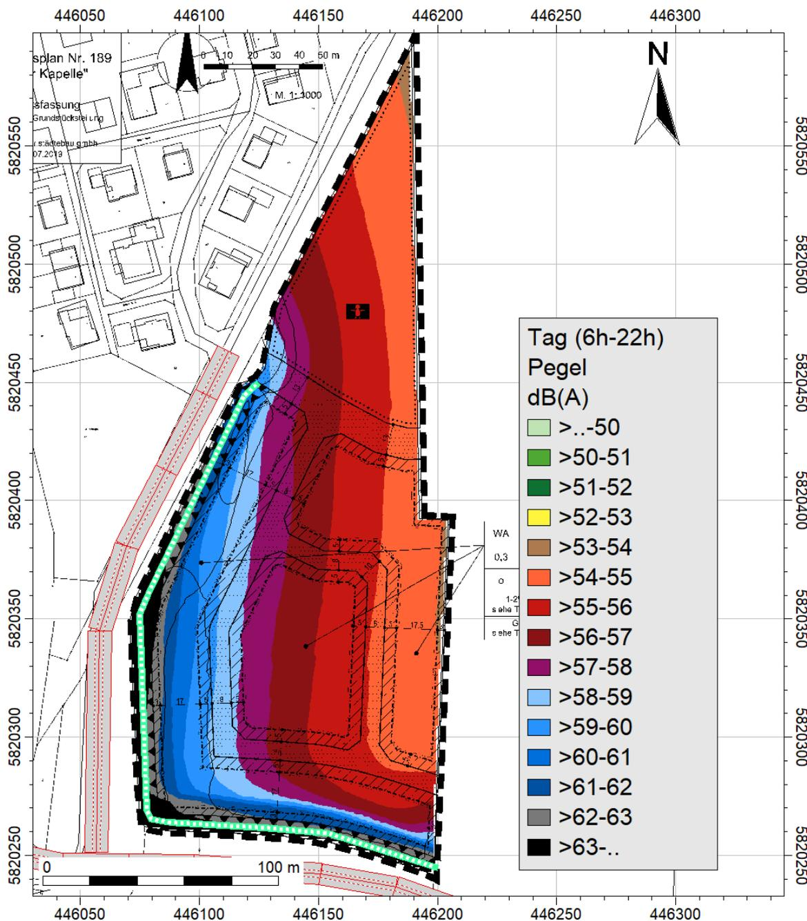
**Abbildung 5:** Beurteilungspegelverlauf im **Tagzeitraum** auf dem Plangebiet unter Berücksichtigung von den Geräuschemissionen durch den Straßenverkehr mit einer 5 m hohen Lärmschutzwand (turquoise Linie), **relative Aufpunkthöhe: 7,6 m** für das Prognosejahr 2030.
