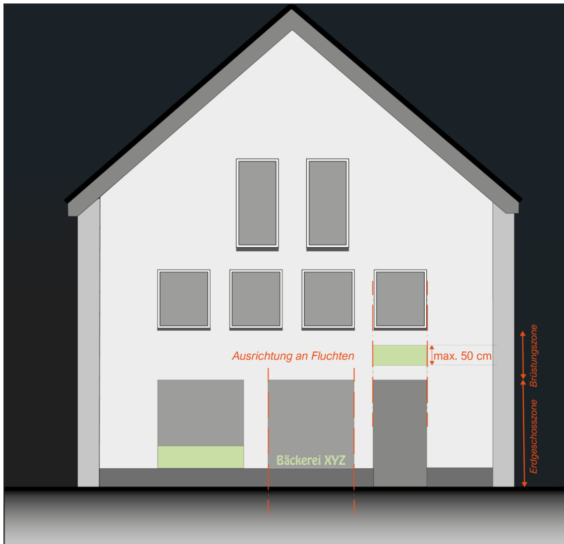
Abbildung 4: Schematische Darstellung des Fluchtbezugsgebotes, Quelle: eigene Darstellung
