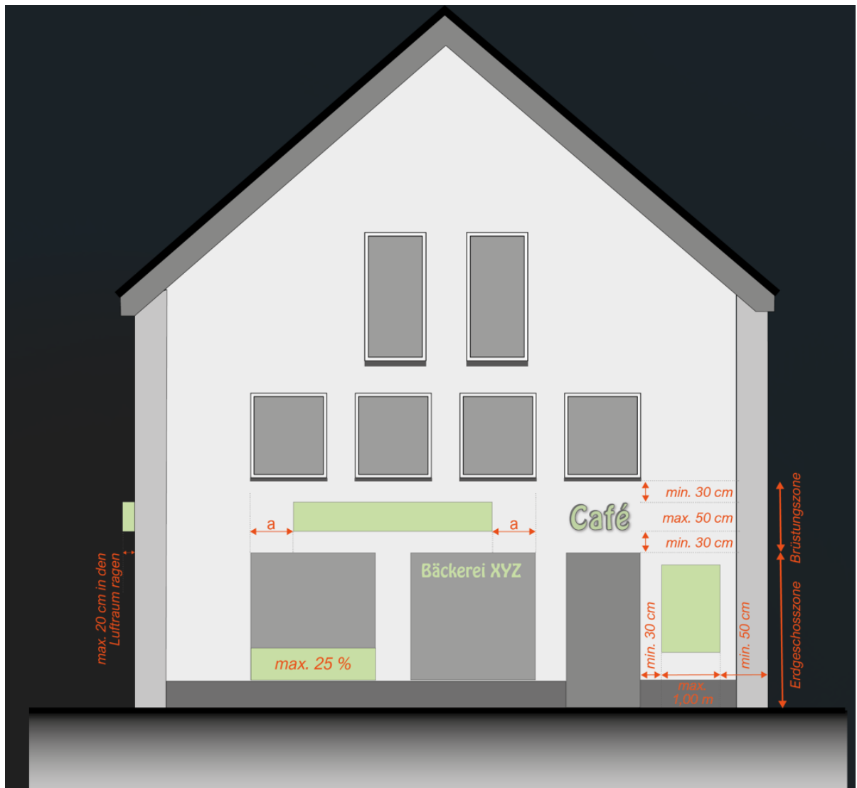
Abbildung 5: Schematische Darstellung der Regelungen zur Fassadenwerbung gemäß § 5.1 dieser Satzung, Quelle: eigene Darstellung
