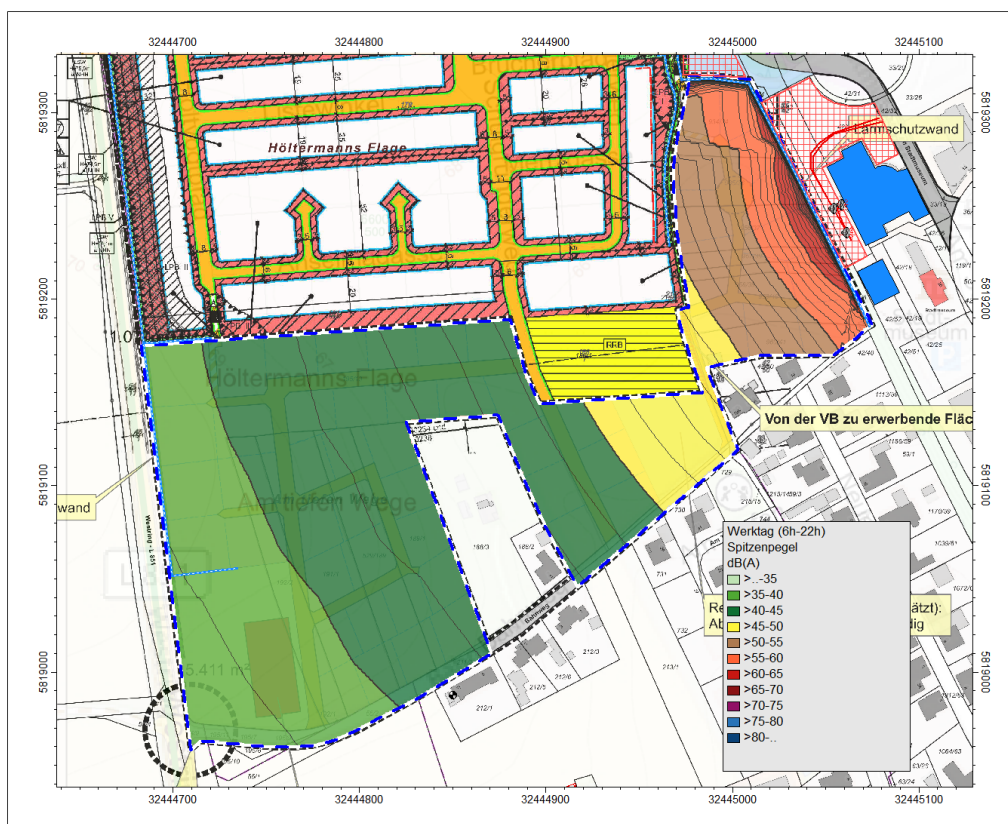
Abbildung B8: Spitzenpegel „Gewerbe“ tagsüber inkl. Schallschutz, EG (4,8 m über Grund).
