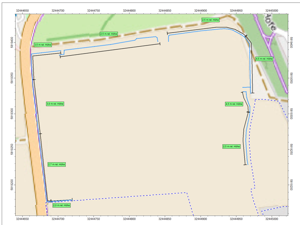
Abbildung 3: Lage der im Geltungsbereich von B-Plan Nr. 166 planerisch vorgesehenen Schallschutzwände, Quelle: /18//19/.
