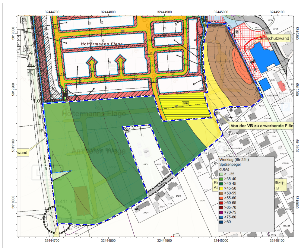
Abbildung B6: Spitzenpegel „Gewerbe“ tagsüber inkl. Schallschutz, EG (2,0 m über Grund).
