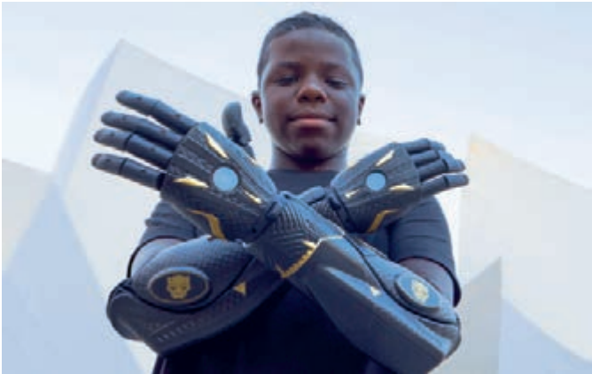
Der Hero Arm, die weltweit erste 3D-gedruckte myoelektrische Armprothese für Erwachsene und Kinder ab acht Jahren, ist nun auch in Deutschland erhältlich.
